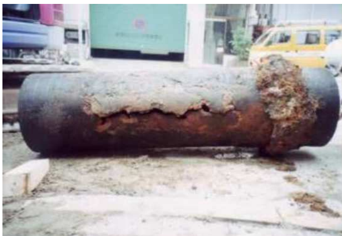
腐食性土壌による管体腐食
