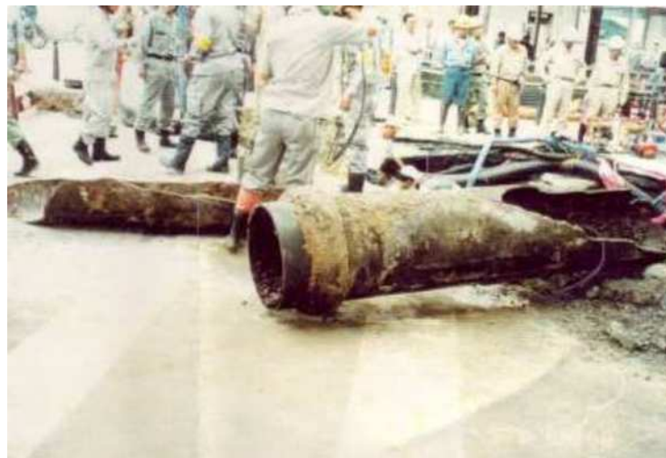
経年化による管体強度の低下
