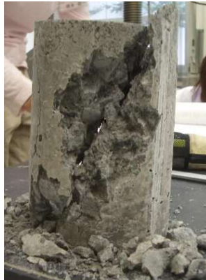
せん断破壊(いきなり壊れる)
