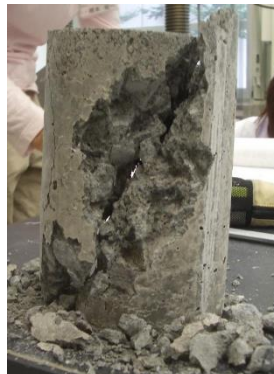
せん断破壊(いきなり壊れる)
