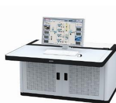
監視制御装置
