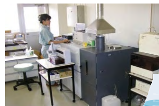
写真：水質分析 ICP発光分析装置による重金属測定 「こんなこともしていました。」
