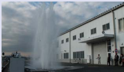
実製品を用いたマンホール蓋の浮上試験
